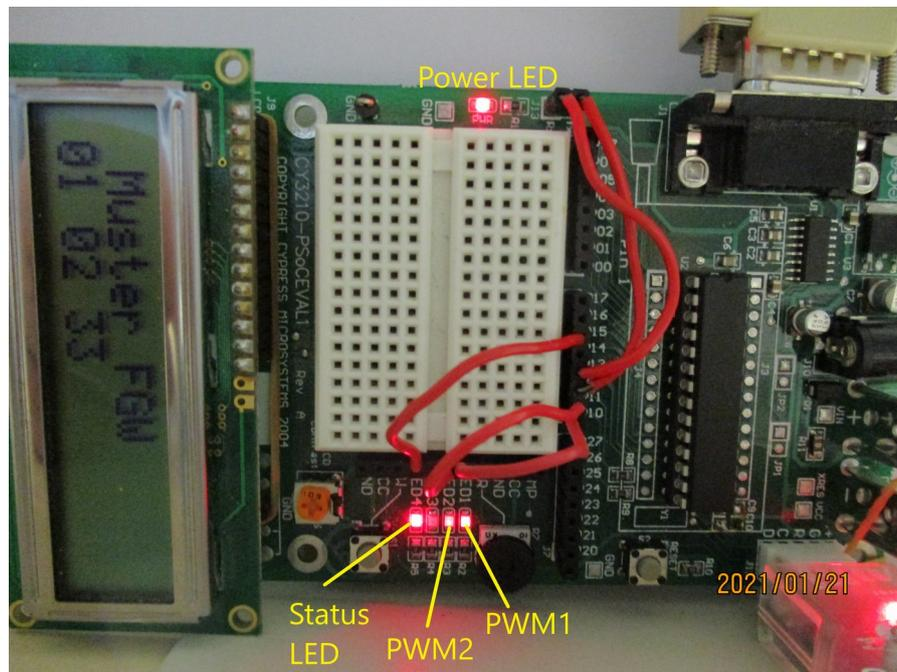
Als Ersatz für das Drucksensorsignal wird über ein Potentiometer eine konstante Spannung verwendet.
